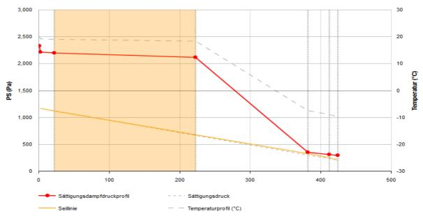
Tauwasser- und Temperaturverlauf nach Glaser (Berechnung gem. DIN 4108-3):
